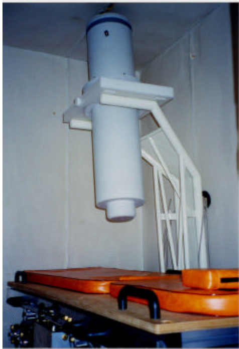
図 3.4 12 チャンネルベクトル型 胎児心磁計の概観写真。
