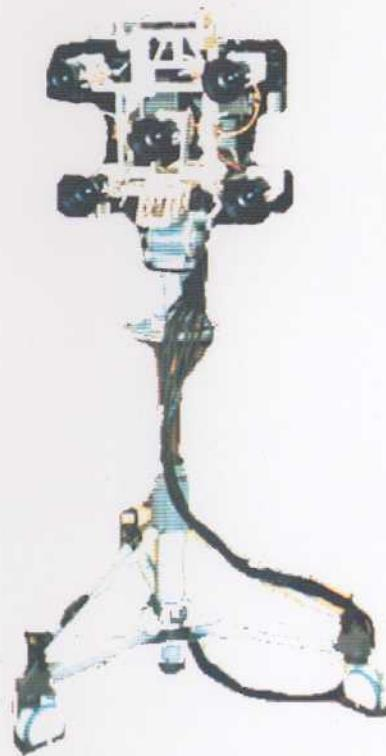
図 F.1: Sony 3D Camera System カメラヘッド
