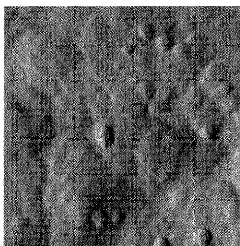
図 4.5: 異なる基板温度 (a) 270\text{ }^\circ\text{C} 、(b) 300\text{ }^\circ\text{C} 、(c) 320\text{ }^\circ\text{C} で ZnTe に CdTe を 3.5 ML 積層した試料表面の AFM 像。スキャンレンジは全て 500 \times 500\text{ nm} 。
