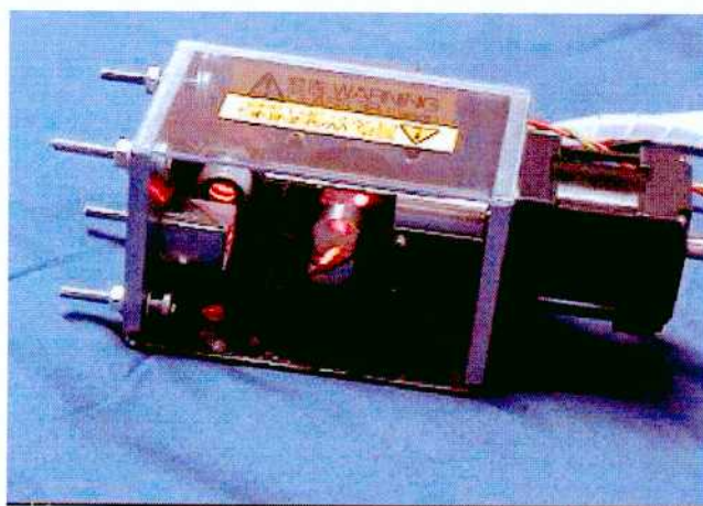
図 3.4: 遠隔操作型レーザーポインタ GestureLaser
