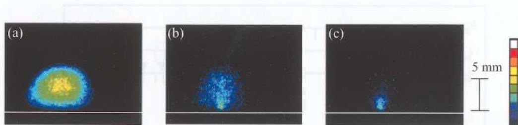
図 3.4 アブレーションプラズマの CCD 像。時間遅延は(a) 0.2 ms、(b) 0.4 ms、(c) 0.6 ms である。白線はターゲット位置である。CCD ゲート幅 \tau_G は 0.1 \mu\text{s} で測定した。
