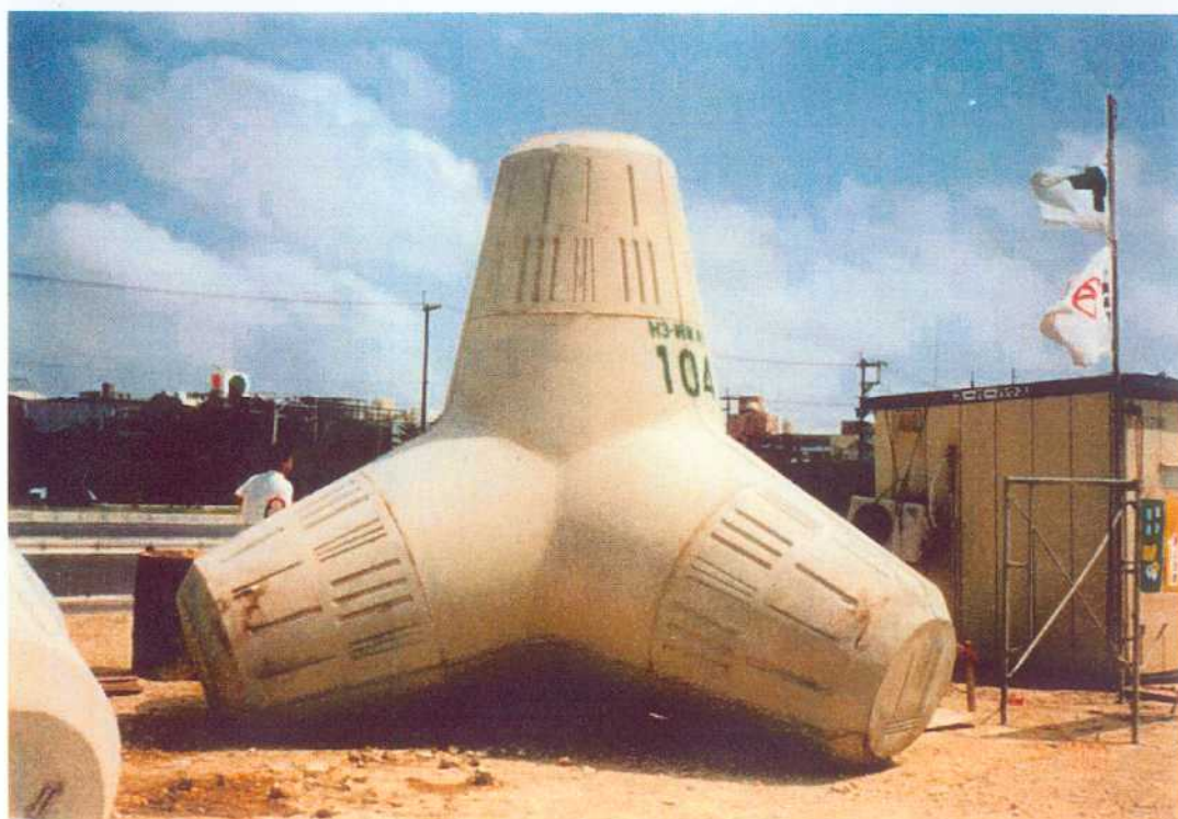
図 5-2 凹凸加工実験区の状況
