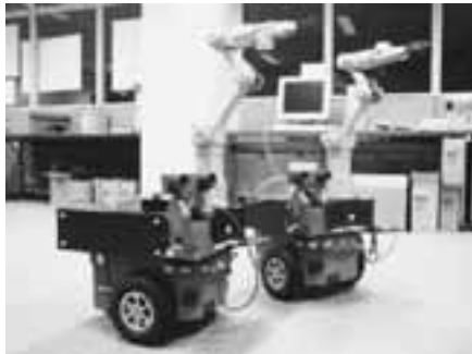
図5 両眼カメラ、軽量マニピュレータを搭載した移動ロボット
