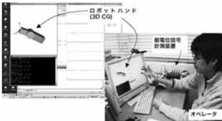
図1 筋電位信号を利用したヒューマン-マシンインタフェイス
