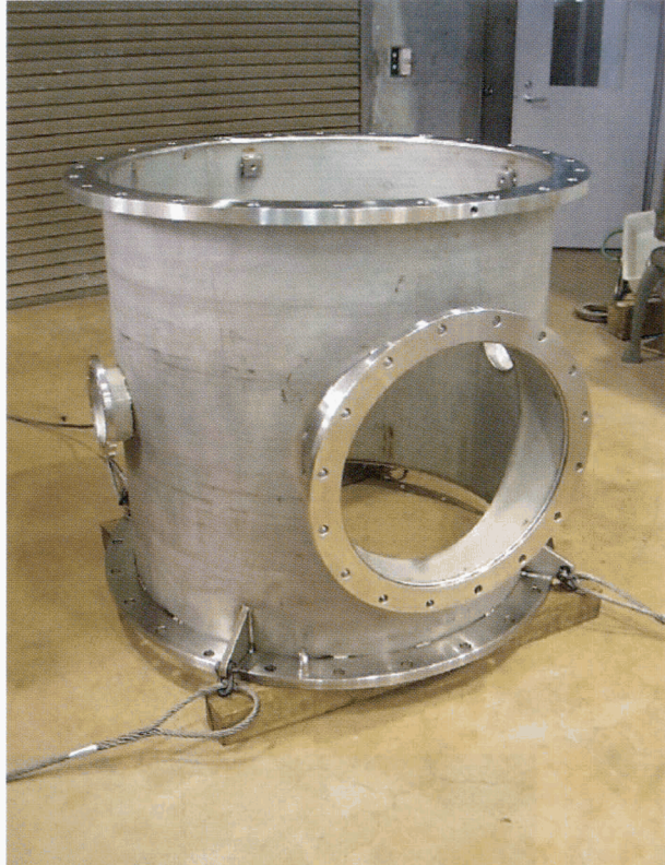
NBI入射タンク延長管 (プラズマ研究センター)
