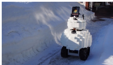
図 2: 柔らか素材による雪だるま型外装を持つ移動ロボット(2017 年度試作)
