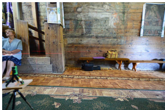
図 12. レーザー墨出機による測定
