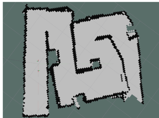
図 3.13: 作成したコースと SLAM によって作成した環境地図
