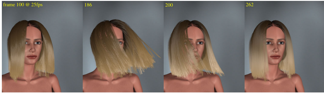
図 1.5: SPH を用いて毛髪同士と毛髪と空気の相互作用を統一的に計算した手法 [3]
