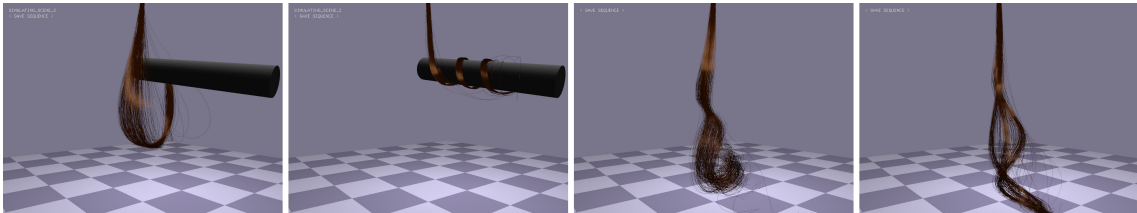
図 1.4: 側鎖結合を考慮した毛髪の塑性変形シミュレーション [2]
