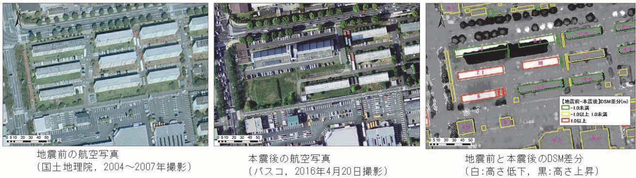
図-10 建物の新築・撤去により DSM 差分が大きく変化する例
