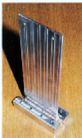
振動試験用試験体：SUS304 (機械工學系：平成12年12月)
