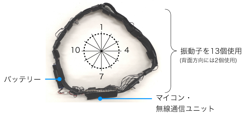
Figure 3.5: 振動提示デバイスの構成
