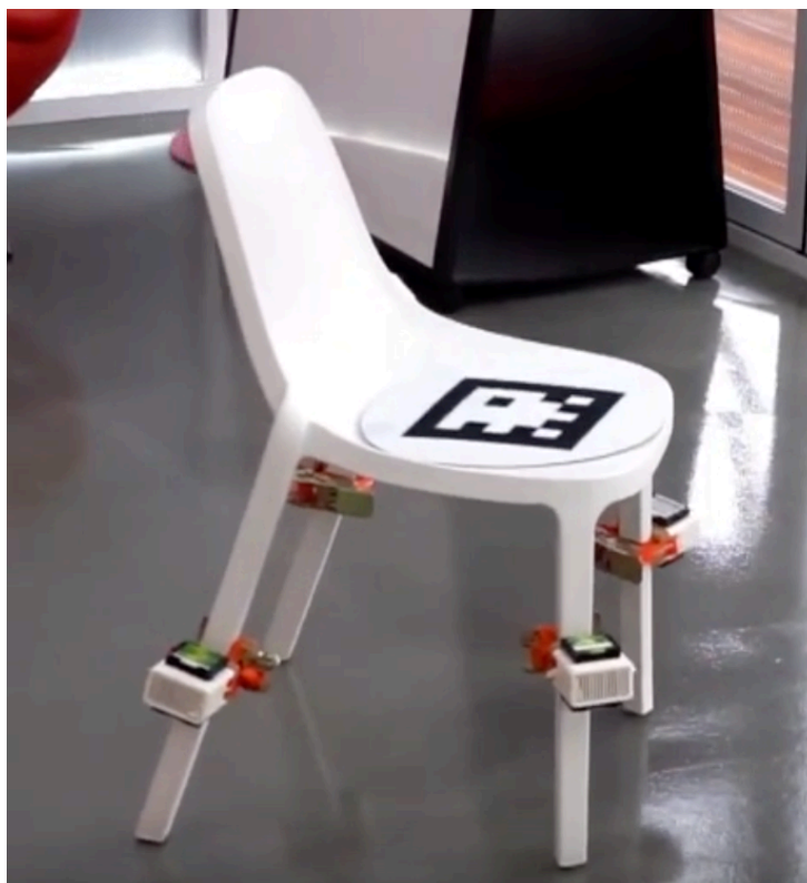
図15 Tetiana らの振動を用いた駆動機構
