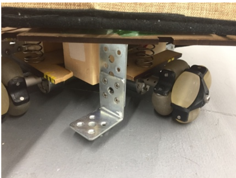
図22 ニゲルイスの駆動部、及び荷重分散機構
