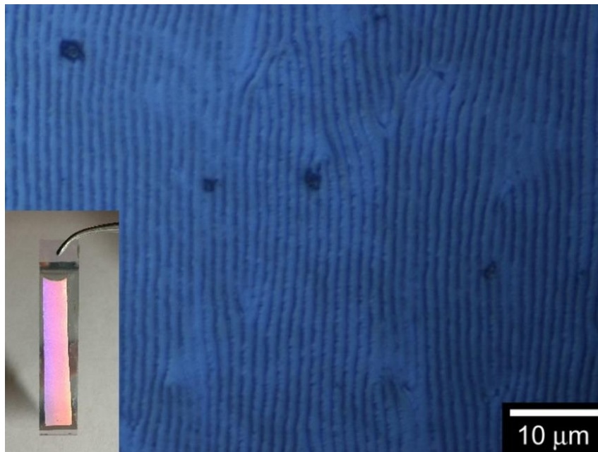
Figure 12. Poly(F-Flu)-Ch-6T に銀コーティングを行った Poly(F-Flu)-Ch-6T-Ag の反射顕微鏡観写真。挿入写真は同サンプルの写真。
