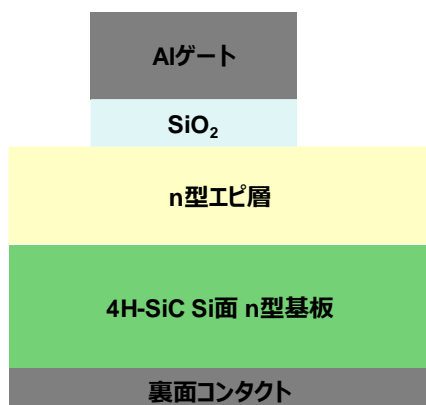
図 2.2 (a) SiC n 型基板 MOS キャパシタ形成プロセス (b) SiC n チャネル MOSFET 形成プロセス
