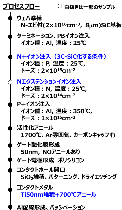
図 4-2 3C-SiC と Ti によるコンタクトプロセスを適用したプレーナ型 MOSFET の作製フロー
