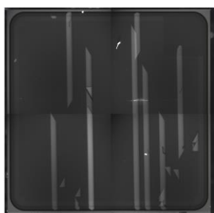
図 2-8 帯状欠陥発生後の フォトルミネッセンス像
