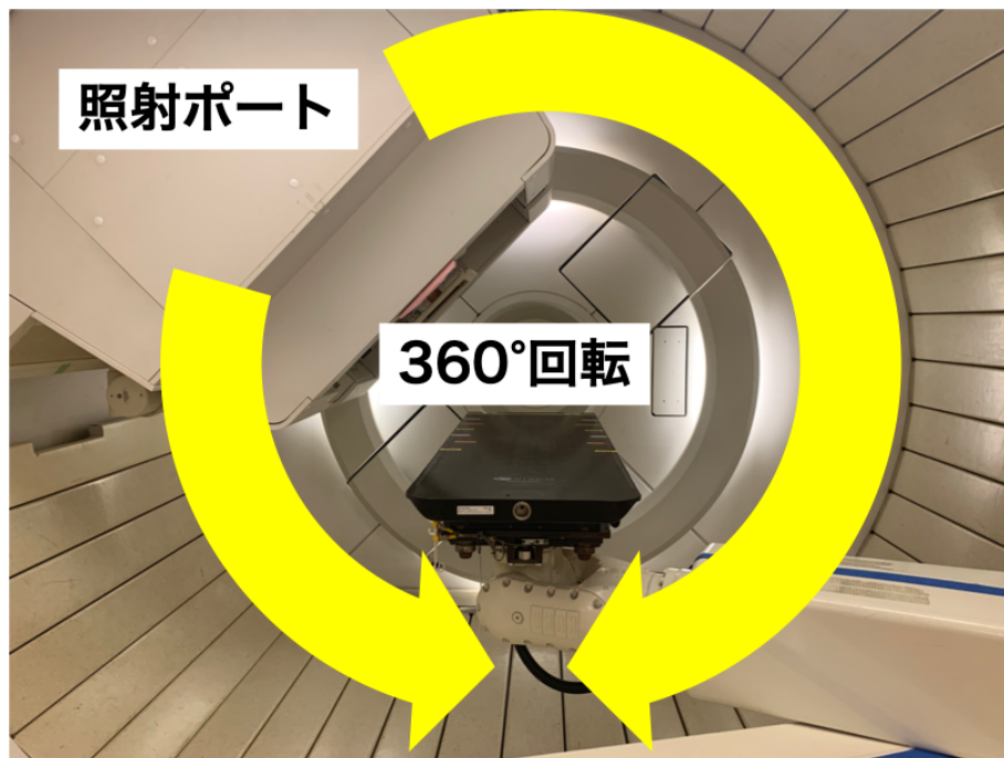
図 1-8 陽子線治療装置の照射ポート（回転ガントリ）
