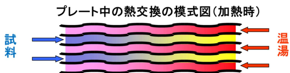
図 1-5 プレート式熱交換器の外観(a)および構造(b)
