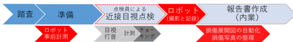
図7-11 近接目視点検前後にロボットを用いて撮影と記録を行い、損傷展開図作成の自動化までの手順(ユースケース C)
