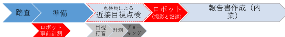
図7-9 近接目視点検後にロボットを用いて撮影と記録を行う手順(ユースケース A)
