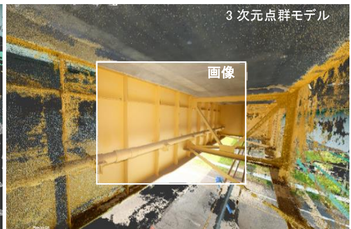
図6-30 撮影画像と3次元モデルの重ね合わせ
