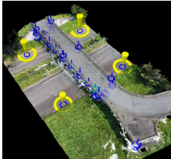
図6-25 遠景撮影から構築した3次元モデル ～評定点と検証点を表示(Pix4Dmodelで作成)～
