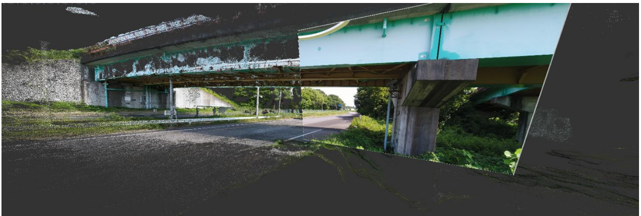
図6-31 SfMにより822枚の画像から生成した3次元点群モデルとUAV撮影画像の重ね合わせ ～3次元モデル上で画像の撮影位置が明瞭に判る特長を有する～
