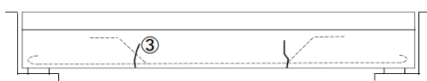
図6-1 支間1/4, 主桁直角方向の桁下面, 又は側面の鉛直又は斜めひび割れ
