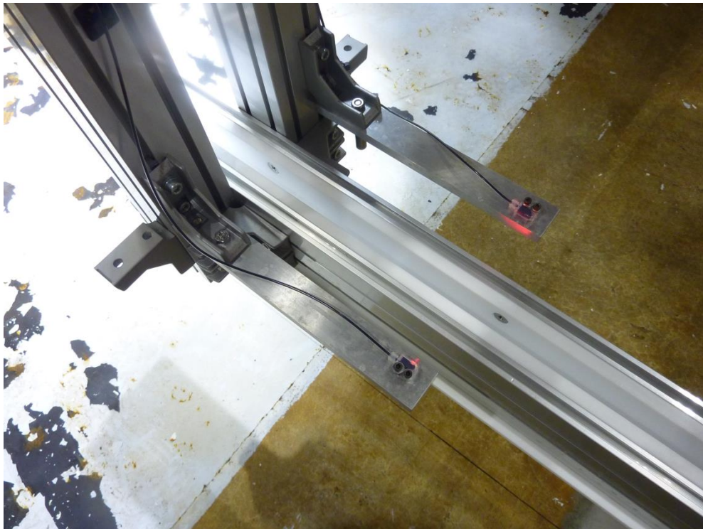
図 3-6 データ収録トリガ用センサ
