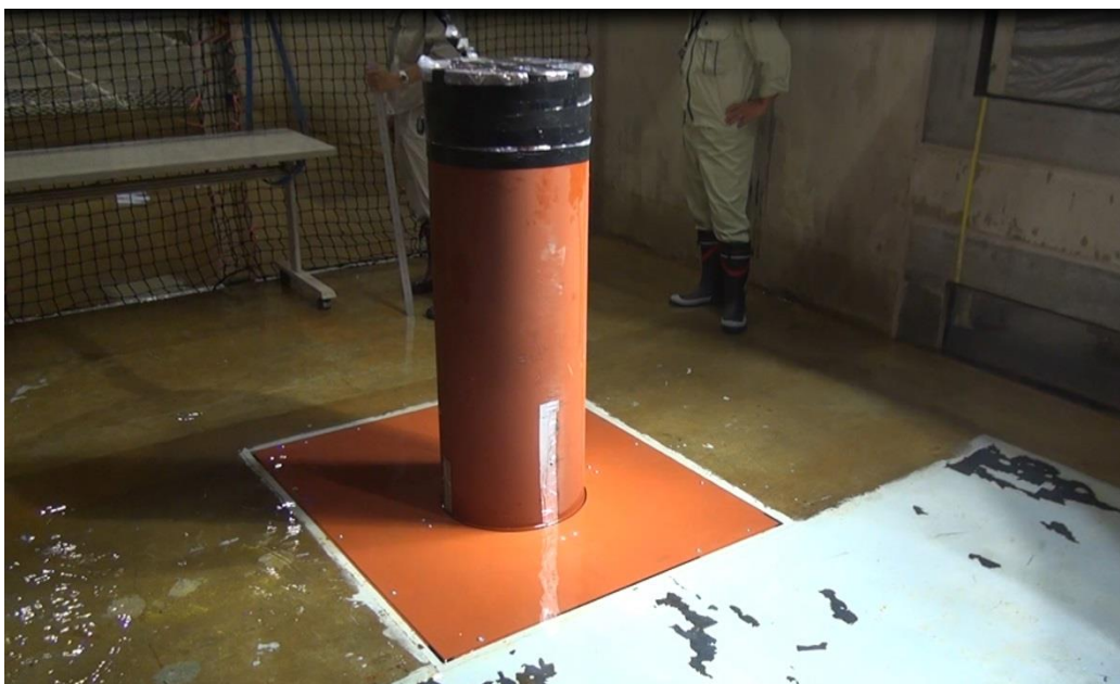
図 3-22 衝突速度評価試験の円筒被衝突体
