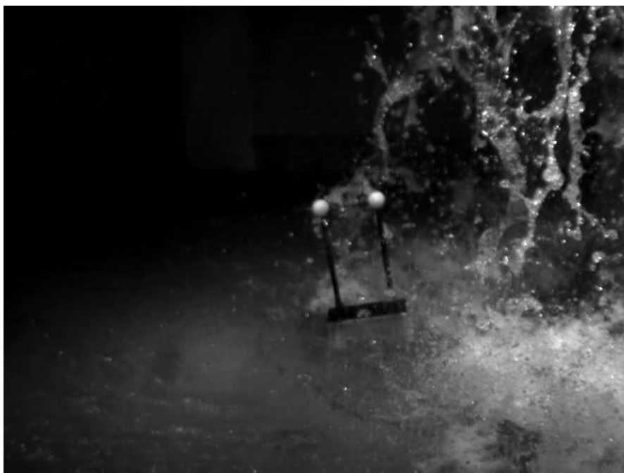
図 3-38 試験ケース114-2の高速度カメラ画像（円筒被衝突体） （漂流物：100×100×200mm，比重0.55，流速：5m/s）
