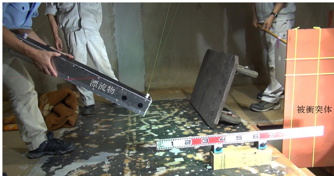
図 3-33 気中衝突試験の状況
