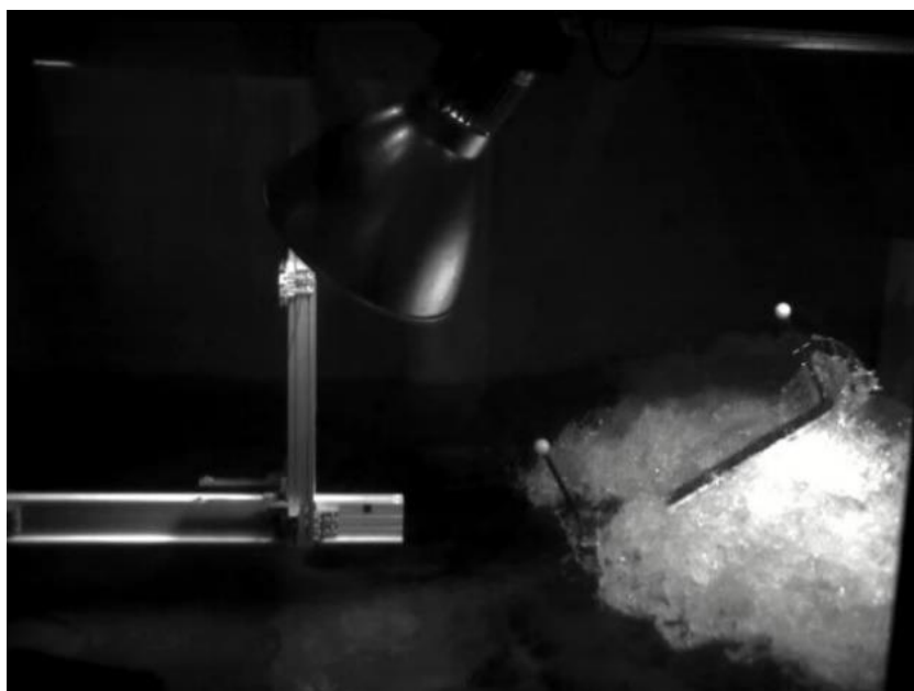
図 3-35 試験ケース103-2の高速度カメラ画像（平板被衝突体） （漂流物：100×100×800mm，比重0.55，流速：3m/s）
