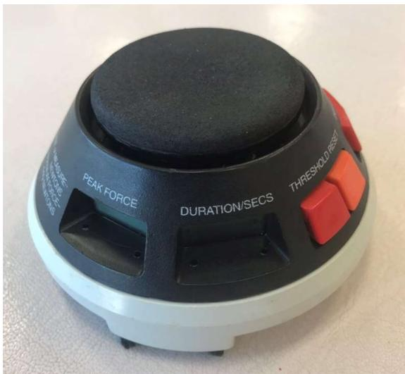
Fig 5-1. Handheld dynamometer Micro FET
