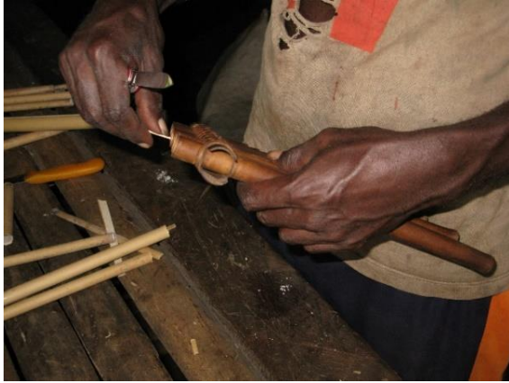
写真 19 棒を差し入れて竹筒の長さを測る(左)
