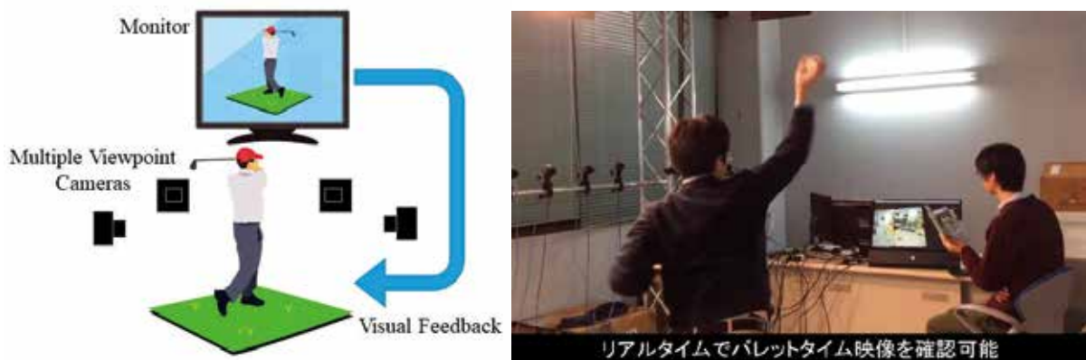
図 3. オンサイト視覚フィードバック方式の構成（左）と自動化された閲覧者の操作（右）
