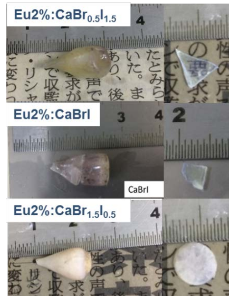
図4：作成した \text{Ca(Br,I)}_2 結晶。Br の割合が異なる3種類を試作した。
