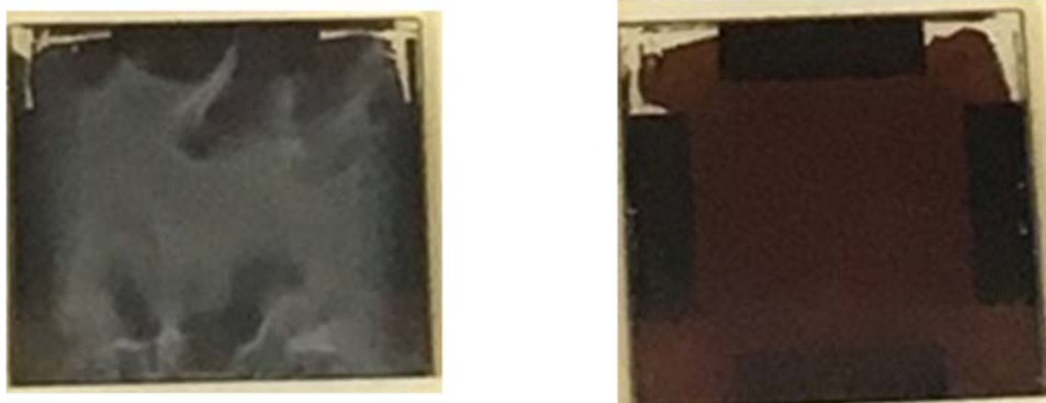
(a) ペロブスカイトの変化（左はガスブローなし、右はガスブローあり）
