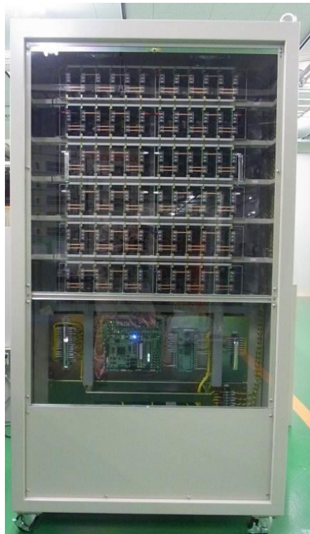
図 2-24 デルタ結線カスケード・マルチレベル STATCOM 試作機
