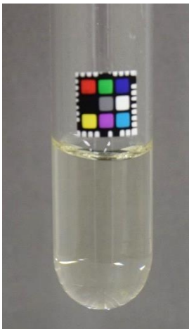
図 4-46 試料 L (生のリンシードを太陽光が当たる屋外にて設置) の 7 日目
