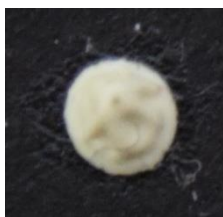
図 5-11 経時によりちぢれ皺を起こしたサンシクンド（未加熱）BO
