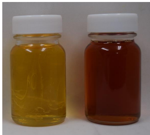
図 3-3 サンシクンドの加熱前 (左)、加熱後 (右) の比較
