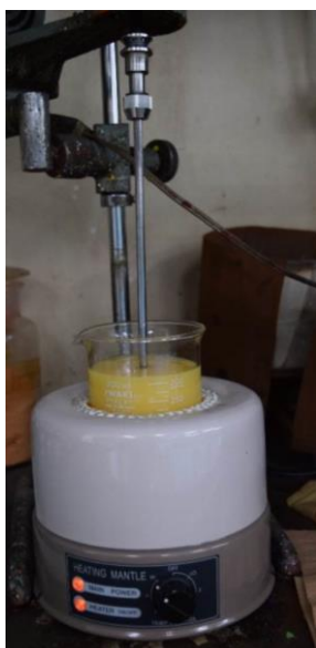
図 4-5 一酸化鉛を添加したオイルをマントルヒーターで温め、連続的に攪拌している様子
