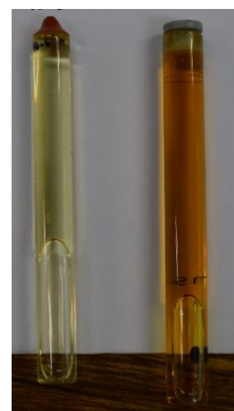
図1 左：サンシクンド未加熱、右：サンシクンド加熱後の粘度と色の見本
