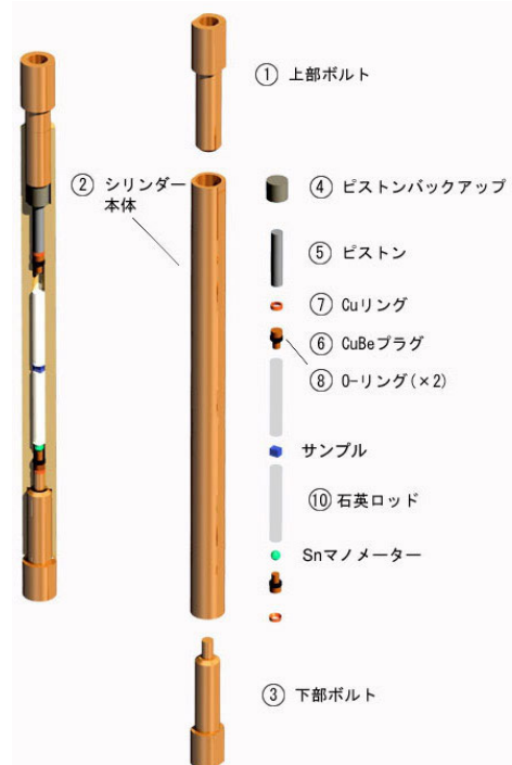
Fig.2-29 : 高圧力下磁化率測定に使用したピストンシリンダーセルの部品構成と全体図 [106].
