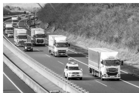
図 6-2 隊列走行の公道走行実験 (走行車線側 3 台, 国土交通省資料より引用)
