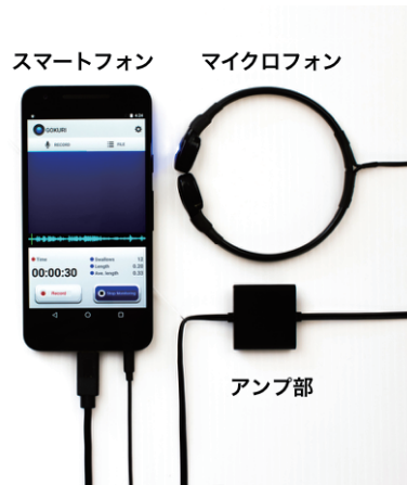
図 4.2: 頸部装着型嚥下モニター（構成）
