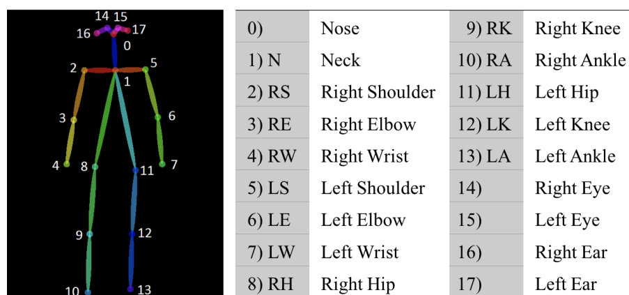
Fig. 5.1: OpenPose により得られる 18 特徴点
