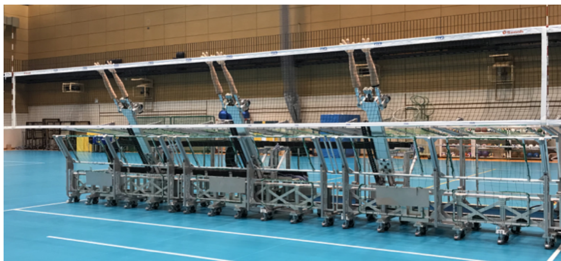
Fig. 4.33: ブロックマシン男女兼用化におけるシステム概要図(男子公式高さにおける初期姿勢)
