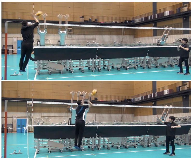
Fig. 5.20: サイド攻撃に対するマシン自動動作 (上：通常のサイド攻撃，下：トスが短くなったサイド攻撃)
