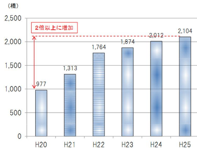
図 1.4 供用停止による通行規制中の道路橋の基数 ([7]より引用)
