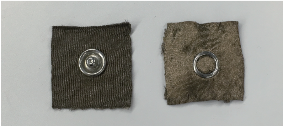
図 5.4 導電布を用いた電極. 右側：肌に接する面. 左側：金属スナップを通じて電位信号が計測される.
