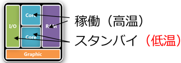
Fig.2-14 LSI デバイスの実際の稼働例(2)
