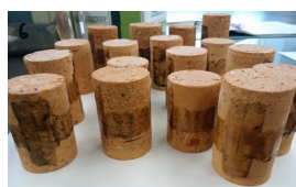
写真2 コア採取された試験体
