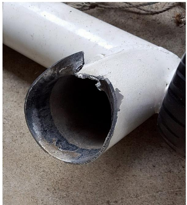
図12 破損したサッカーゴール
