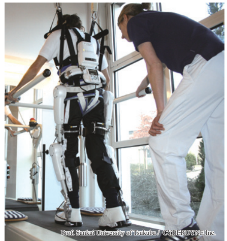
図2：ロボットスーツ HAL 体に装着することによって、人間の身体機能を改善・補助・拡張する世界初のサイボーグ型ロボット
