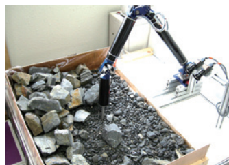
図3：石灰石鉱山における機械の自動化を考える上で研究を行うための油圧フレカを模した大塊岩石ハンドリング実験装置
