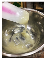
図1 混ぜ続け、粘着質になった状態のカゼイン溶液
