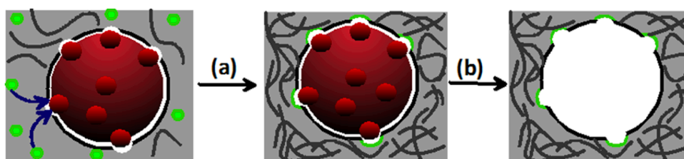
Fig. 1.8. 分子鑄型ポリマーのメカニズム。(a) 機能性モノマーの吸着サイト (緑) が鑄型分子と結合する。(b) 重合された MIP より鑄型分子を取り除くことにより、鑄型分子と同様の形状および吸着サイト配列を持った吸着孔ができる 35 。
