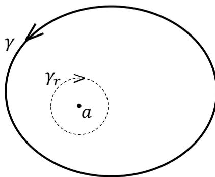
このままでは積分定理を使えないので, 点  $a$  の周りを半径  $r$  の小さな球で囲み, 円周を  $\gamma_r$  と定義する. そして, 以前やったことと同様に  $\gamma \cup \gamma_r$  を考えるわけだが, 閉曲線は左手に内部が見えるように向きをつけるため, 図のように  $\gamma$  と  $\gamma_r$  の方向が異なることに注意する.
