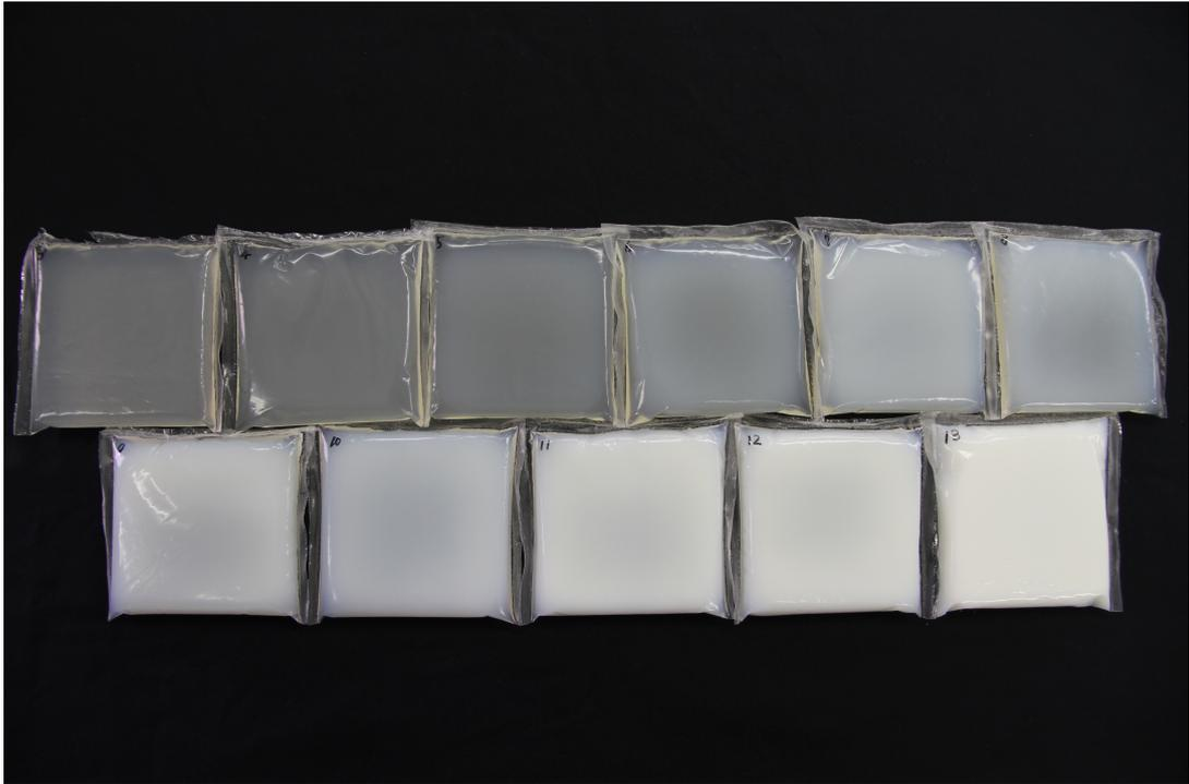
図 2-13  $R_2$  値-線量特性曲線を取得したポーラス型ポリマーゲル線量計
