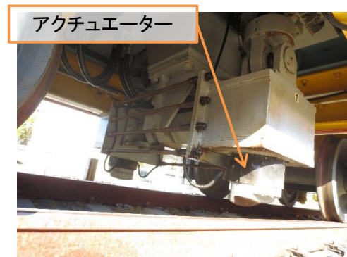
(b) 載荷台車全景 (第2 載荷試験車)
