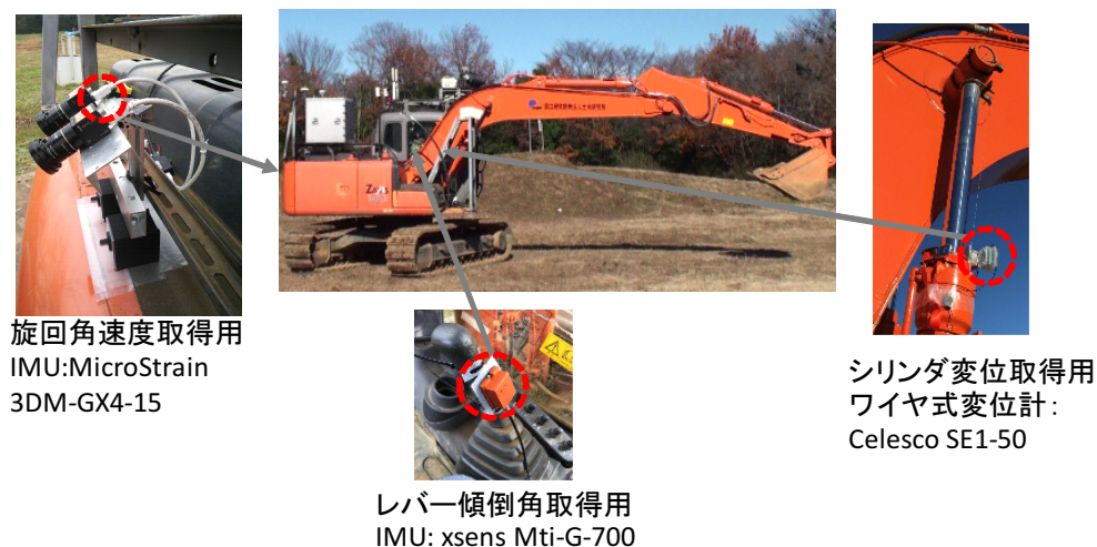
図 2.1: センサ取り付け位置
