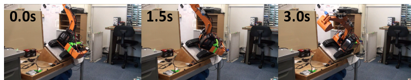
(c) 提案する自動停止 (ZMP 安全領域: \pm 124 \text{ mm} , CoG 安全領域: \pm 120 \text{ mm} )
