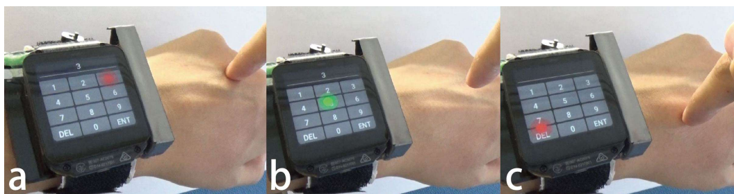
図 4.6 ナンバーキーボードアプリケーション a) タッチングによる入力, b) ホバリングによる位置表示および移動, c) DEL キー
