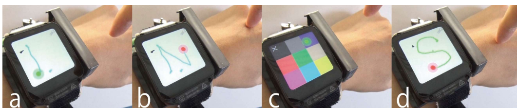
図 4.7 ドローイングアプリケーション a, b) ホバリングによる移動を利用した N の描画, c) カラーパレットによる色選択 (ボタン入力), d) 線形入力による S の描画
