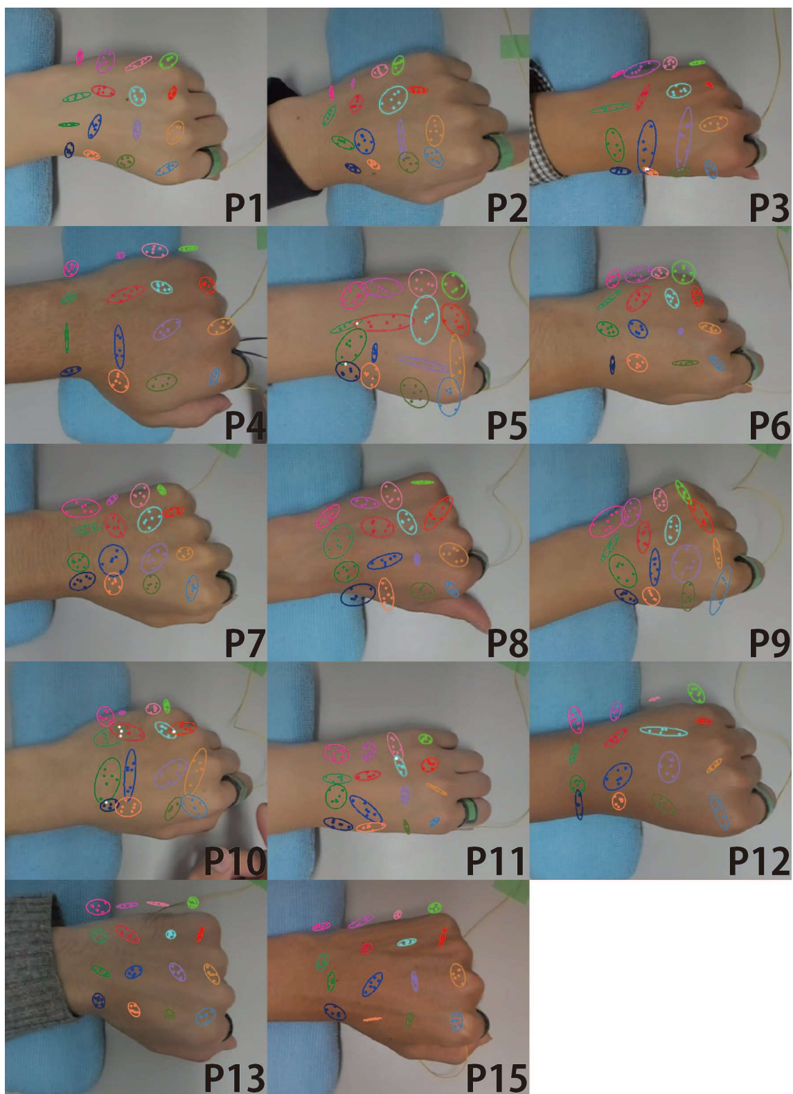
図 B.16 Sighted 16 分割の場合のポインティング位置と 95%信頼楕円 各点はポインティング位置，白色の点は 2 個以上の楕円に含まれるポインティング位置を示す
