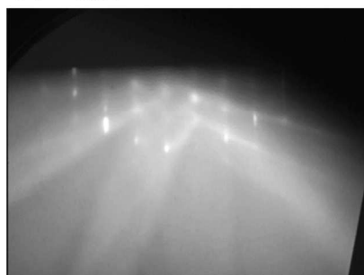
図 4.5 異なる温度で成長させた CdTe 上 SnTe の RHEED パターン
