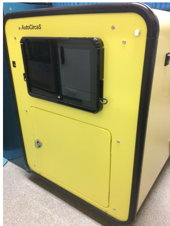
図 5. 小動物サーカディアンリズム自動計測システム(AutoCircaS)
