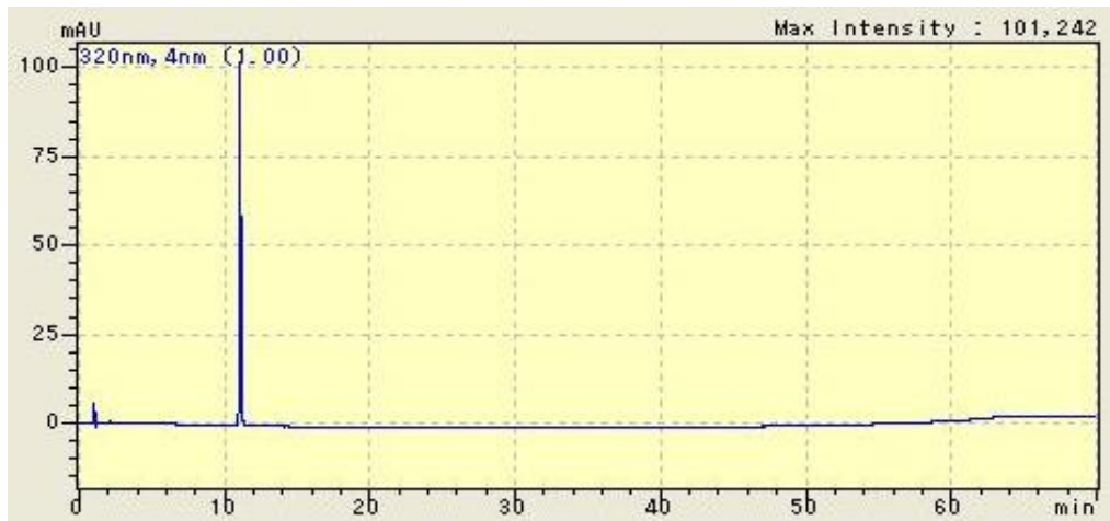
図 2-1 2013 年 9 月に採取したススキ根部 MeOH 抽出物の水層 および chlorogenic acid 標品の HPLC クロマトグラム (320 nm)
